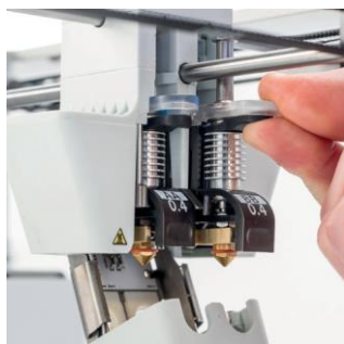
Print core AA 0,25, 0,4, 0,8 mm Le changement rapide minimise les temps d'arrêt
